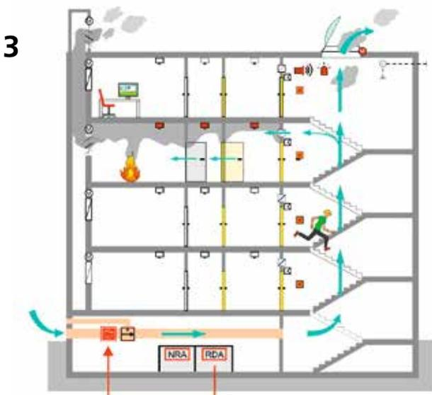
Der Ventilator läuft an. Frischluft wird dem Treppenhaus zugeführt. Der Rauch wird aus dem Treppenhaus gespült. Das Fluchttreppenhaus ist rauchfrei.
