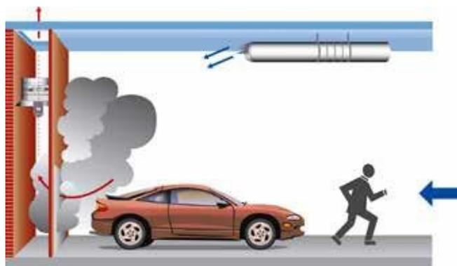
Belüftung und Entrauchung durch das Jet-Ventilationssystem
