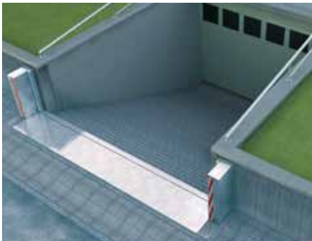
Der Auslöser des Klappschotts ist das Wasser selbst!
